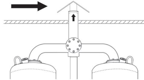
**Protección contra los agentes meteorológicos para una tubería colocada hacia arriba**
